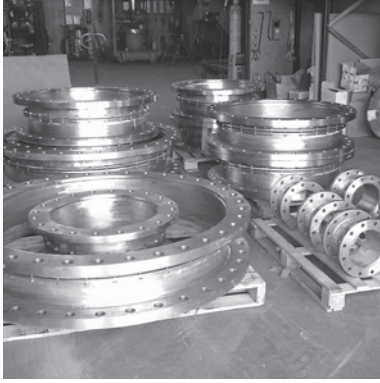
Carretes de desmontaje Dismantling coils
